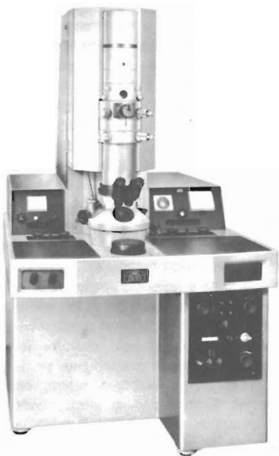
Microscopio elettronico elettromagnetico. Il suo potere di risoluzione si aggira sui 10-12 Å.
